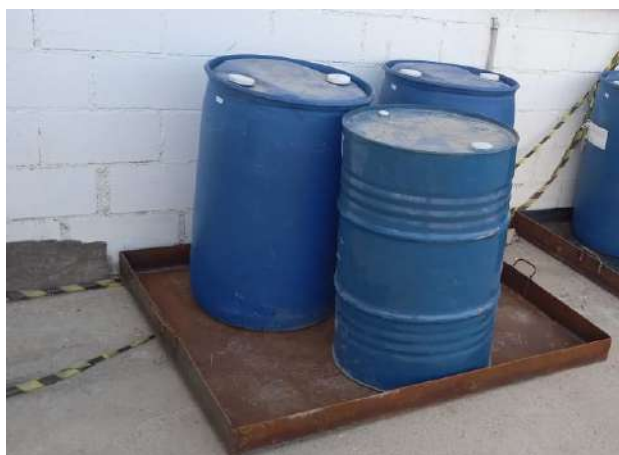
Foto 59 – Tambores de Produto Perigoso armazenado em bandeja de contenção. (Data:11/07/2022)
