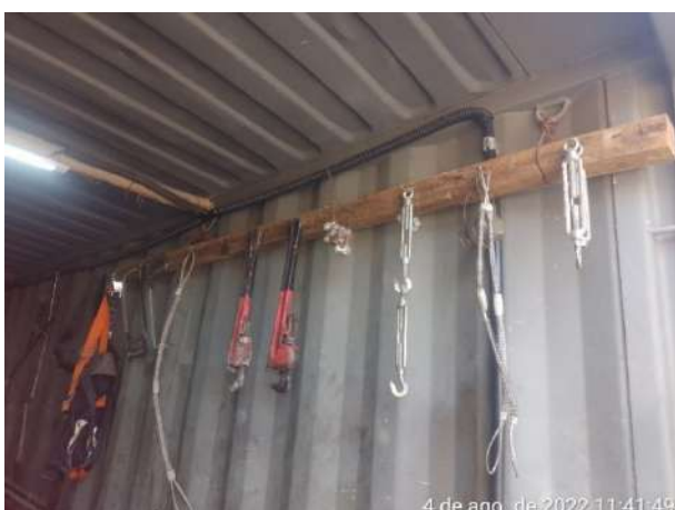
Foto 123 – Reutilização de sobras de madeira para fabricar suporte. (Data:04/08/2022)
