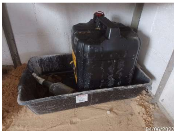
Foto 35 – Galão de Produto Perigoso armazenado em bandeja de contenção. (Data:04/06/2022)
