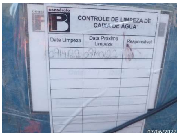
Foto 105 – Ficha de controle de limpeza fixada na caixa de água disposta na frente de serviço. (Data:07/06/2022)
