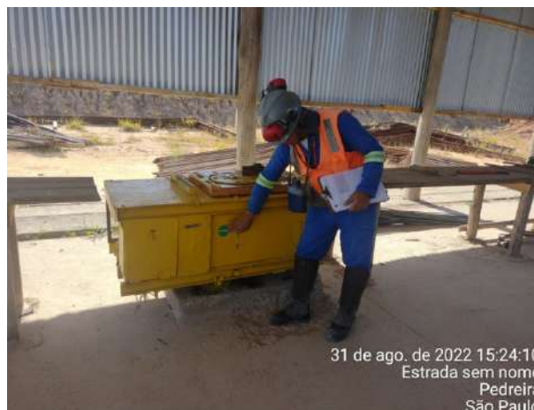
Foto 140 – Dobradeira inspecionada na frente de serviço. (Data:31/08/2022)
