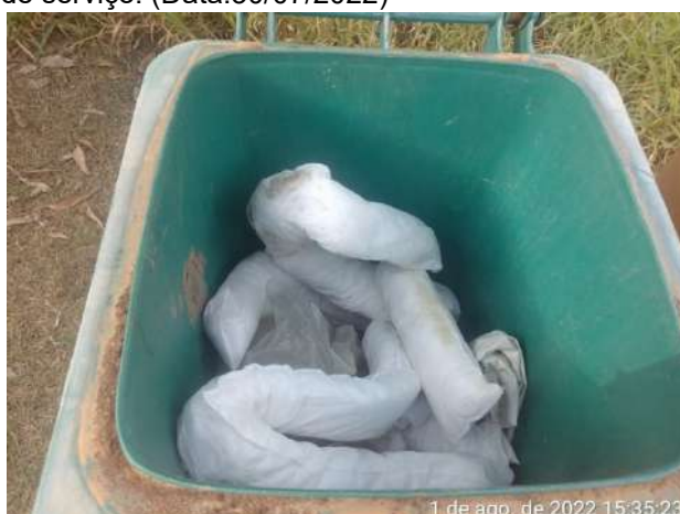
Foto 63 – Cordões e ferramentas, em detalhe, dispostas nos tambores dos Kits de emergência ambiental na frente de serviço. (Data:01/08/2022)
